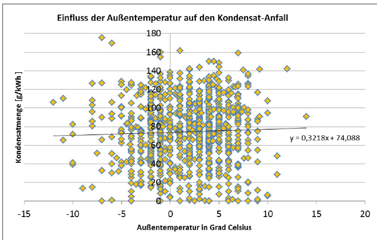
17 Prozent der Geräte werden **raumlufthängig** betrieben, die anderen raumlufunabhängig. In der Untersuchung gab es keine signifikante Abweichung zwischen den Kondensat-Erträgen in beiden Gerätegruppen. Möglicherweise wurden aber durch die einfache Versuchsanordnung bei etlichen raumlufthängigen Systemen aber Kondensat-Mengen aus dem Abgasweg erfasst, die der Brennwertnutzung tatsächlich nicht zugutekommen.
